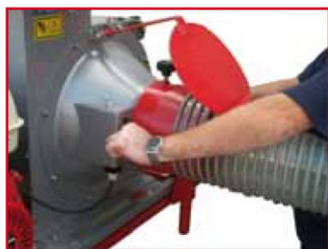
Système de raccord rapide du tuyau
