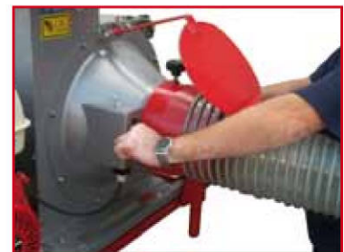
Système de raccord rapide du tuyau
